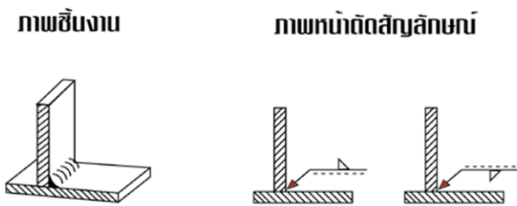
4.แนวเชื่อมฟิลลิกเชื่อมด้านลูกศร
